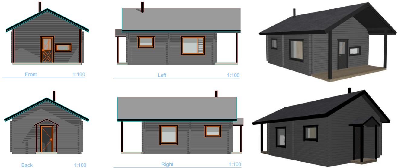
Kuva 11. Kaava-alueelle tuleva rakentaminen vaalii perinteistä rakentamistapaa. Majoitusrakennukset ovat suhteellisen pieniä (alle 40 k-m 2 ), ne ovat harjakattoisia ja väriykseltään tummia. © B&B Adventures Oy 2023.
