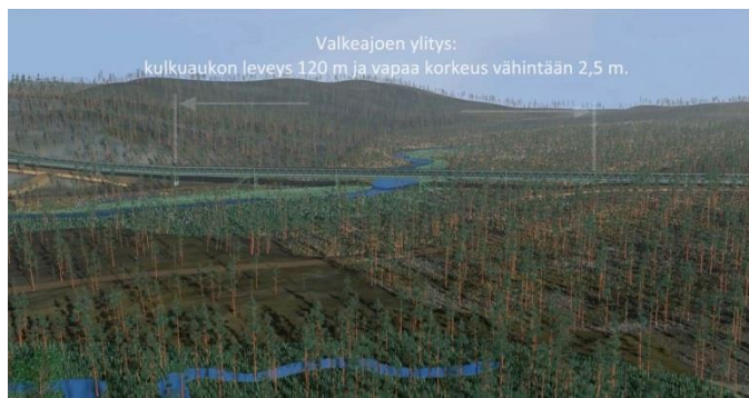
Kuva 6-21 Kuljetin ylittää Valkeajoen noin 170 m pitkällä sillalla (kuvakaappaus videosta, Diff Design Oy).
