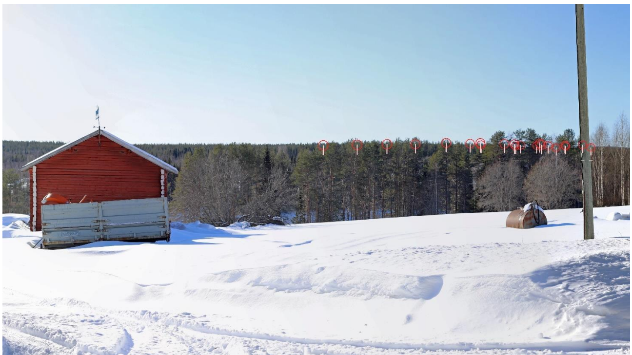
Kuva 11.17 Havainnekuva Lohinivalta. Etäisyys kuvauspisteestä voimaloihin on noin 15,9–21,4 kilometriä. Keskimmaisessä ja alimmassa kuvassa on havainnollistettu voimaloiden tornit valkoisilla viivoilla ja lapojen pyörimisalueet punaisilla ympyröillä. Tarkennus vastaa noin 50 mm polttovälin objektilla otettua valokuvaa (todellisuudessa silmällä havaittava näkymä).
