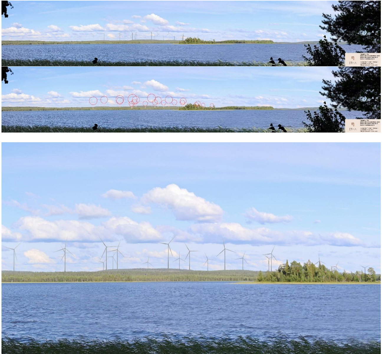
Kuva 11.14 Havainnekuva Tirroniemeltä. Etäisyys kuvauspisteestä voimaloihin on noin 4,6–11,6 kilometriä. Keskimmäisessä kuvassa on havainnollistettu voimaloiden tornit valkoisilla viivoilla ja laipojen pyörimisaluet punaisilla ympyröillä. Tarkennus vastaa noin 50 mm polttovälin objektilla otettua valokuvaa (todellisuudessa silmällä havaittava näkymä).
