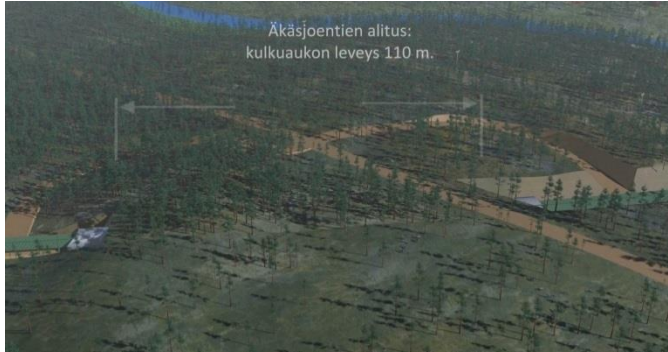
Kuva 6-19 Kuljetin alittaa Äkäsjoentien noin 110 m pitkässä tunnelissa (kuvakaappaus videosta, Diff Design Oy).
